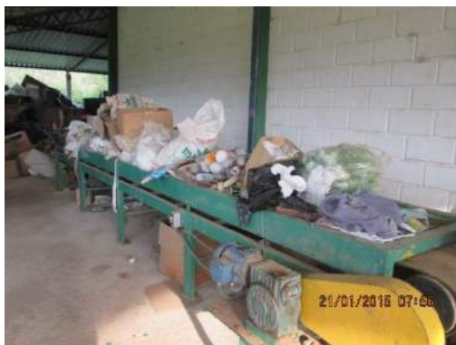
Figura 53 - Esteira para triagem dos resíduos parada por falta de espaço e pessoal no CTR
