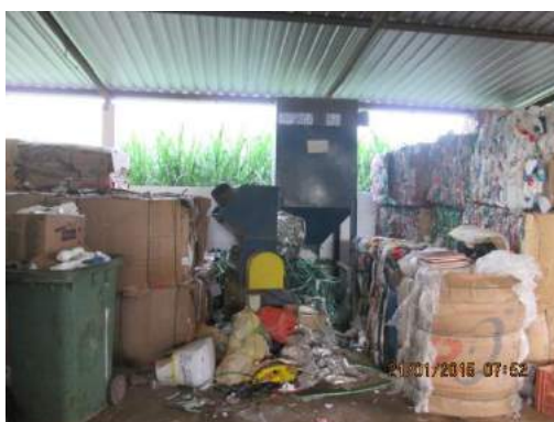
Figura 54 - Triturador de resíduos parado por falta de espaço e pessoal no CTR
